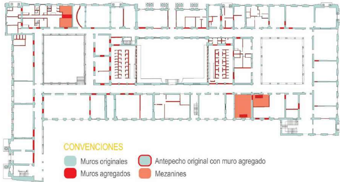
Figuras 191: Ubicación de muros agregados de Primer Piso Fuente: Elaboración consultoría NVP sobre Planos de Levantamiento Consultoría NVP arquitectos 2018.
