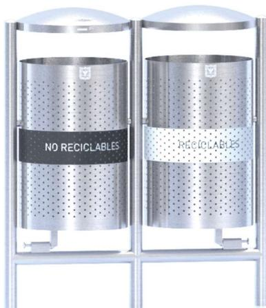
Elemento cilíndrico de aseo de alta resistencia al vandalismo, fabricado en acero inoxidable para depositar desechos menores producidos por el peatón. Se compone de una pieza principal en lámina de acero inoxidable perforada y soldada que pivota para su vaciado sobre parales tubulares de apoyo de sección redonda. Cuenta con una tapa en la parte superior que también se fija a los parales.
