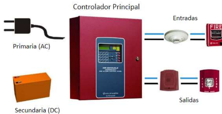
Ilustración 6 – Panel de control principal
