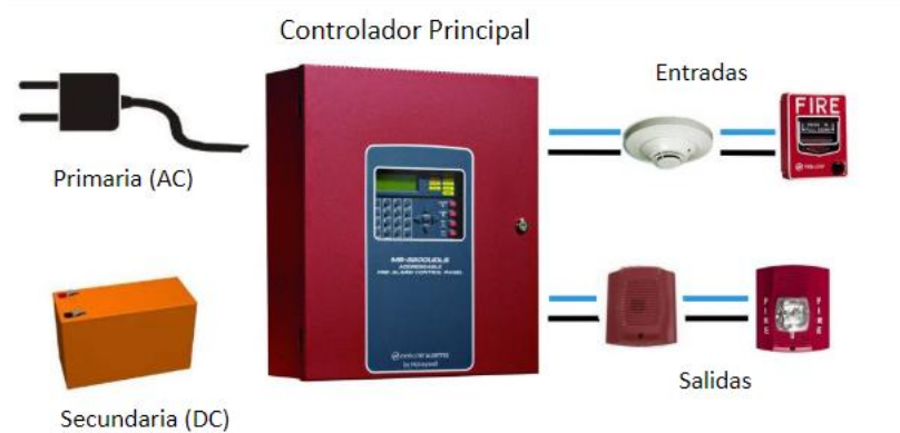
Ilustración 12 – Panel de control principal
